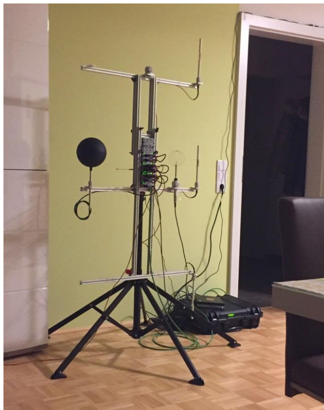
Abb. 38 Behaglichkeitsmessbaum während der Messung, Fernwärme-Wohnung
