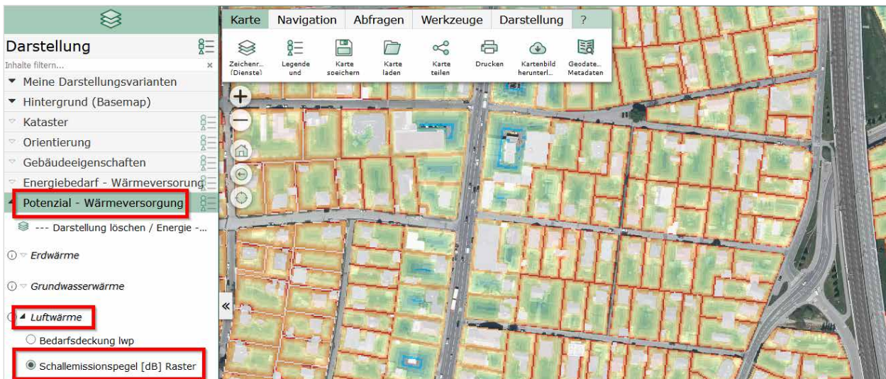
Abbildung 8: Layer „Luftwärme“ – max. zulässige Schallemission der Luftwärmepumpe
