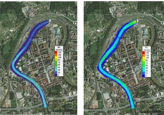
Abb. 6: Vergleich der ermittelten Sohlschubspannungen [N/m 2 ] bei HQ1; links: mit Haltung STZ, rechts: Absenkung am Wehr um 1,5 m [10]
