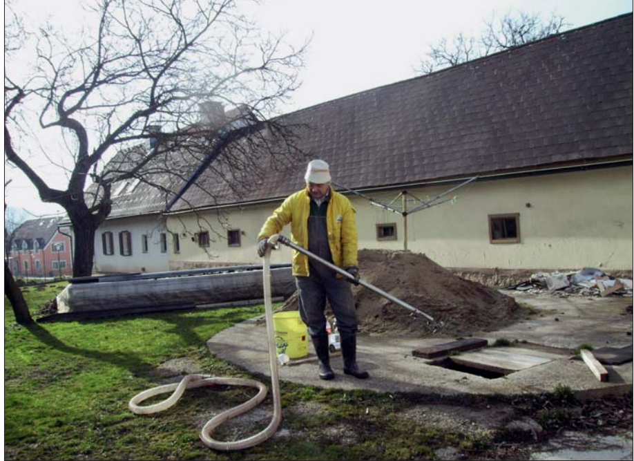
Abb. 2: Stechlanze zur Güllebeprobung
