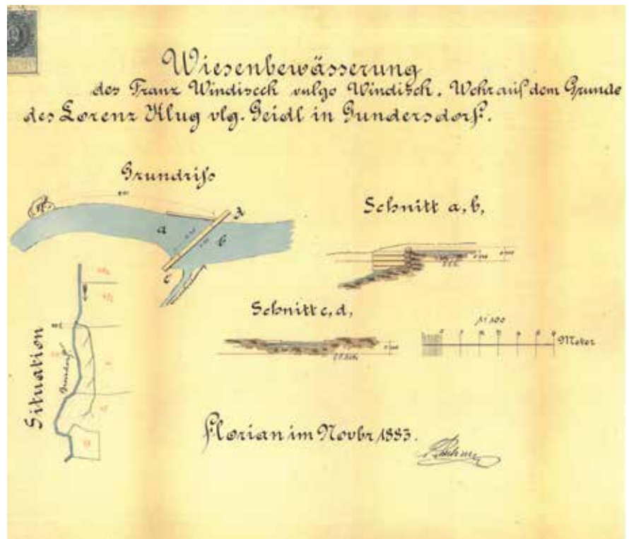
Abb.1: Plan für die Wiesenbewässerung des Franz Windisch in Gundersdorf aus dem Jahre 1853 © A14/Wasserbuch
