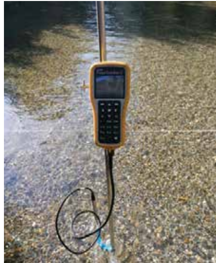
Abb. 3: Handheld des Flowtrackers zur Speicherung und Auswertung © A14
