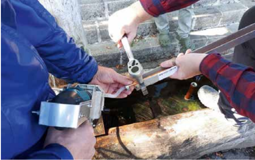
Abb. 1: Die fachgerechte Probenahme zur Helium-Analyse ist recht aufwendig. Dazu eine Anleitung der Universität Bremen (2016): „Mit einem durchsichtigen Schlauch Kupfer-Rohr mit Pumpleitung verbinden - einen kurzen Schlauch auf das andere Rohrende stecken und verengen, so dass sich der Wasserdruck erhöht oder Ventil und Manometer anbringen - das Rohrende mit dem Abfluss (kurzer Schlauch) schräg (ca. 45°) aufrecht halten - das Rohr (40 ml) mindestens zehnmal spülen, d.h. min. 500 ml durchfließen lassen, dabei mit einem harten Gegenstand auf den Behälter schlagen, um Luftblasen von den Rohrwänden zu lösen - erst oben, dann unten fest zuschrauben: die planen Oberflächen der Klemme müssen dicht aufeinander liegen!“ © A14/Michael Ferstl
