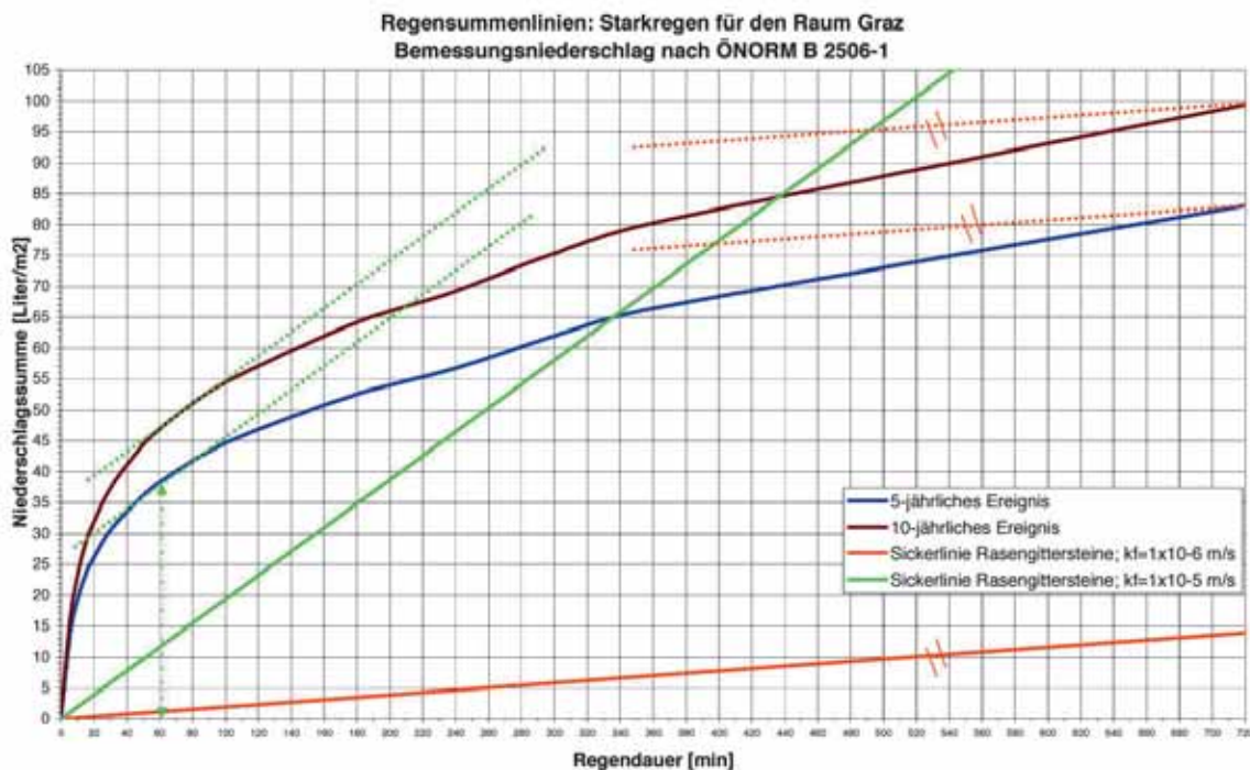
Abb. 6: Abhängigkeit des Bemessungsniederschlags vom Durchlässigkeitsbeiwert des Untergrundes für die Versickerung über eine begrünte Sickermulde
