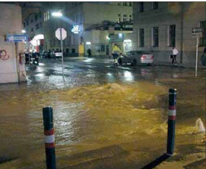
Abb. 5: Überflutung durch Bruch einer großen Versorgungsleitung (Foto: Wiener Wasserwerke)
