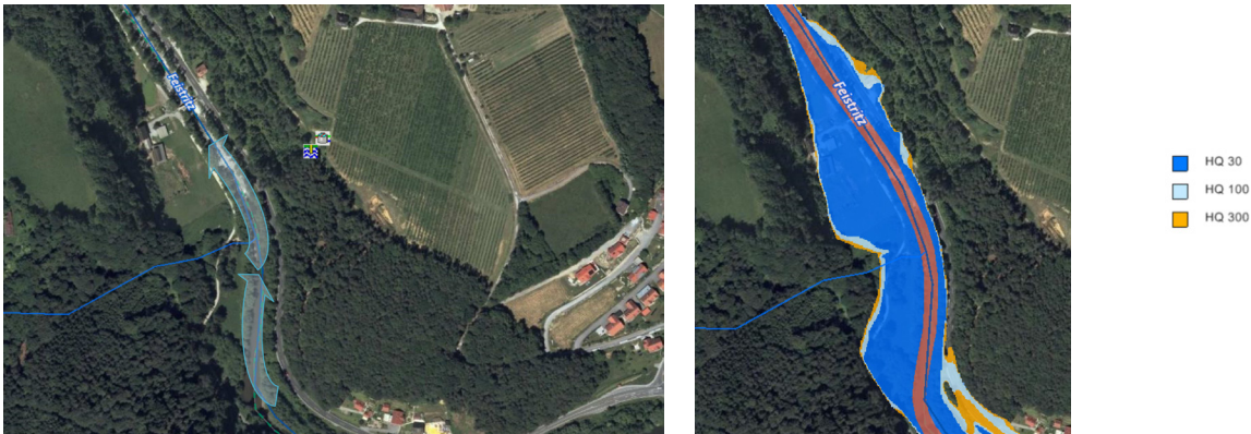
Abbildung 54: Maßnahmenbereich fkm 51,80 – 52,13(ii) Überflutungsflächen (re)
