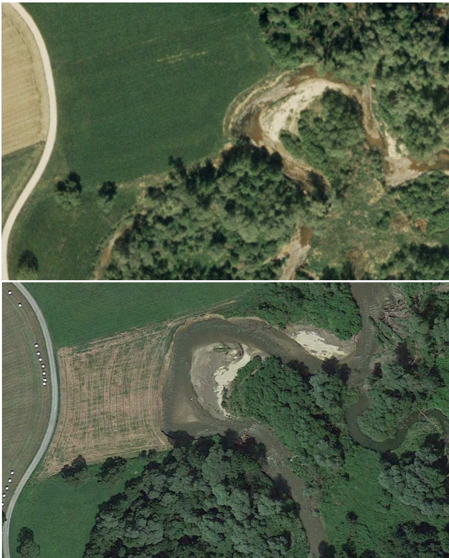
Abb. 18. Laterale Erosion in Abschnitten ohne Ufergehölze zwischen 2000 (oben) und 2012 (unten). Quelle: Google Earth, Abschnitt Loipersdorf-Kitzladen.
