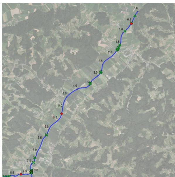
Abb. 3. 1: Querbauwerke im Saggaubach (grüne Markierungen) und deren aktuelle Einstufung der Passierbarkeit (Datengrundlage: Amt der steiermärkischen Landesregierung).
