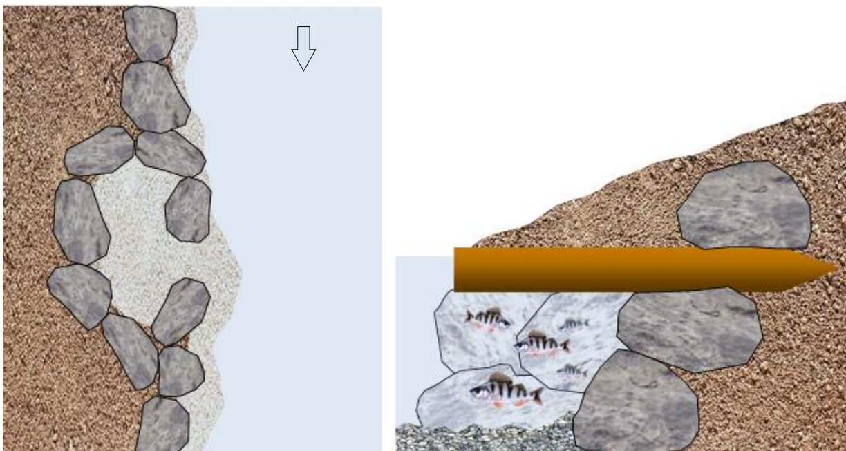
Abb. 5.9: Typskizze (Grundriss links, Querschnitt rechts) einer Steinhöhle als strömungsberuhigter Unterstand für diverse Fischarten. Darstellung: © TB Umweltgutachten Petz.
